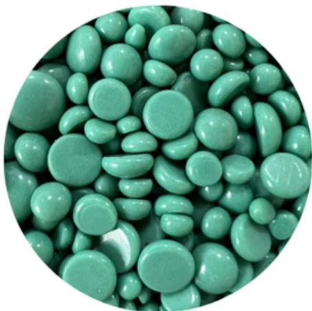
Plastowax H 35G представляет собой полусферы зеленого цвета диаметром до 7 мм. Ему свойственны хорошая заполняемость пресс-форм и четкое их воспроизведение, высокая текучесть, отсутствие взаимодействия с материалами пресс-форм и огнеупорных покрытий, низкая прилипаемость к поверхности пресс-форм, хорошая смачиваемость огнеупорной суспензией.
